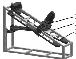
图 5 基于改进运动特性的拉拽式胡萝卜收获装置
