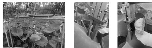
(a) 莲蓬采摘示意图 (b) 剪切面 (c) 夹持面
