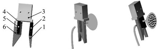
(a) 莲蓬夹持剪切装置 (b) 剪切面示意图 (c) 夹持面示意图
