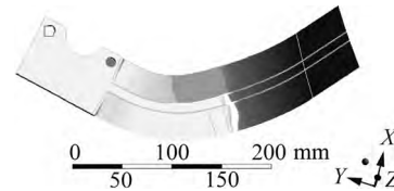
图9 弯刀边界条件(固定支撑为两个螺孔)
