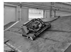
(c) 横向倾翻试验台架试验
