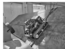
(a) 纵向倾翻试验台架试验(前)
