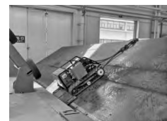
(b) 纵向倾翻试验台架试验(后)
