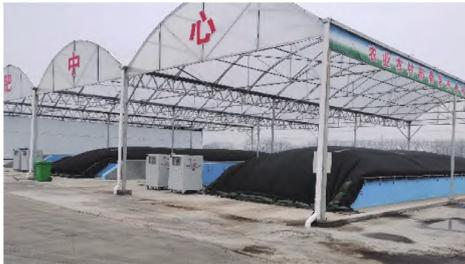
智流膜生物发酵反应装置
