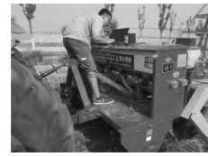
图 4 免耕播种机振动测试 Fig. 4 No-till seeder vibration test
