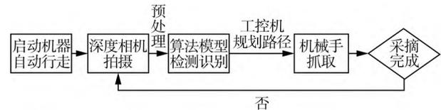
图 2 机器运行流程
